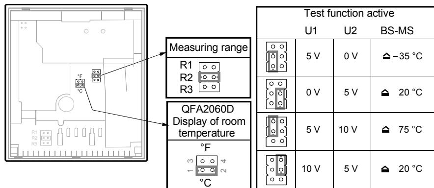
Элементы управления расположены внутри корпуса, состоят из блока 6 штырьков и перемычки. Они применяются для выбора диапазона температур и активизации режима тестирования. Датчики с LCD имеют второй элемент управления для задания °C или °F.
