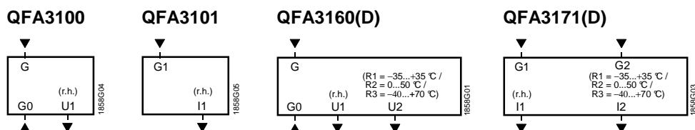
G, G0      рабочее напряжение AC 24 В (SELV) или DC 13.5...35 В,
