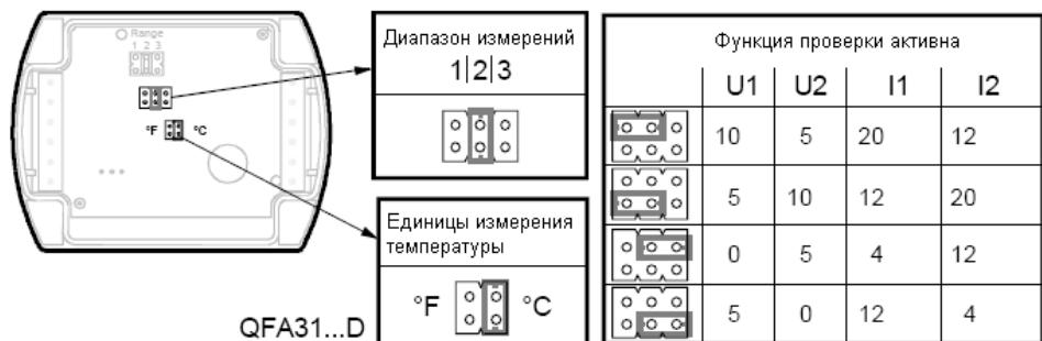
Установочный элемент находится внутри крышки. Он имеет 6 штырьков и перемычку. Данный элемент предназначен для выбора необходимого диапазона измерения температуры, а также для включения функции проверки. Модели с дисплеем LCD имеют второй установочный элемент с 4 штырьками и перемычкой.
