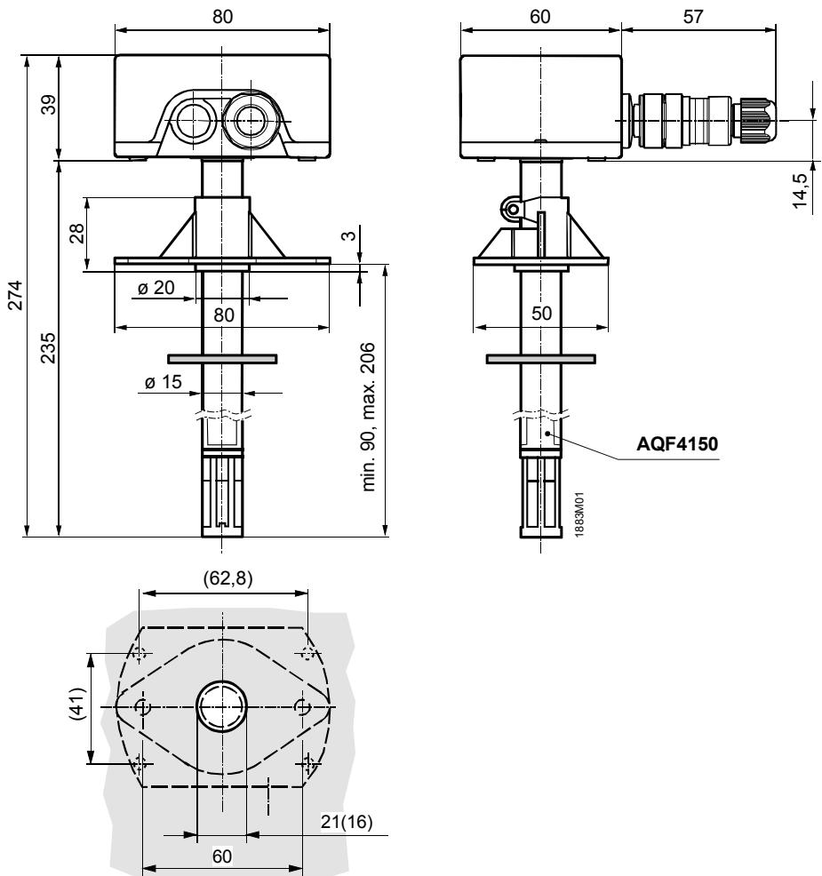
Схема сверления (без) монтажного фланца
