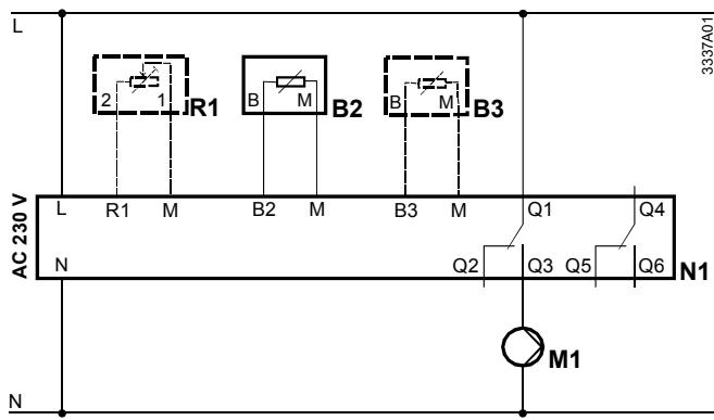
Дифференциальный контроллер температуры с удаленным задатчиком уставки и 2 датчиками наружной температуры, с максимальным ограничением. Управление загрузочным насосом (например приложение №1)
