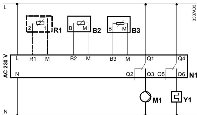
Дифференциальный контроллер температуры с 2 датчиками наружной температуры. Управление загрузочным насосом и 2-точечным приводом (например приложение № 3)
