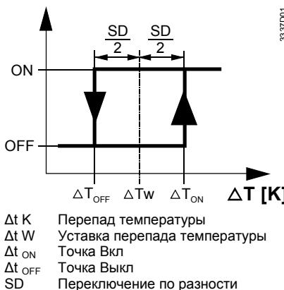
Если температура подачи (B2) превысит температуру потребителя (N1) до уставки ( $\Delta t_{ON}$ ), контроллер переключает реле Q1–Q3, это переключение соответствует режиму ON. Если эта разность опустится ниже значения ( $\Delta t_{OFF}$ ), контроллер переключает реле Q1–Q2, это переключение соответствует режиму OFF.
