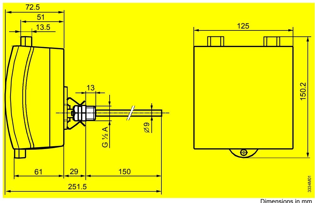
Контроллер с защитным кожухом
