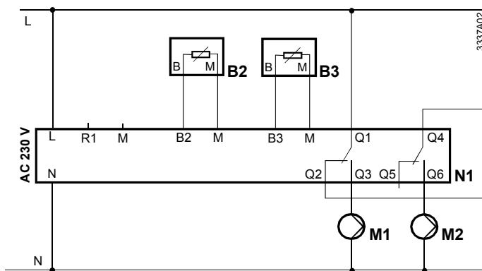
Дифференциальный контроллер температуры с датчиком освещенности и датчиком температуры накопительного бака. Управление насосами (например приложение №2)
